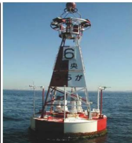
Εικόνα 2. 2: Δίπλωμα ευρεσιτεχνίας του Γάλλου Pierre-Simon Girard εν έτει 1799 (αριστερά) και πλωτός σημαντήρας με τεχνολογία ταλαντευόμενης στήλης νερού του Ιάπωνα Yoshio Masuda (δεξιά) (Πηγή: Hosna Titah-Benbouzid, Mohamed Benbouzid, 2015).
