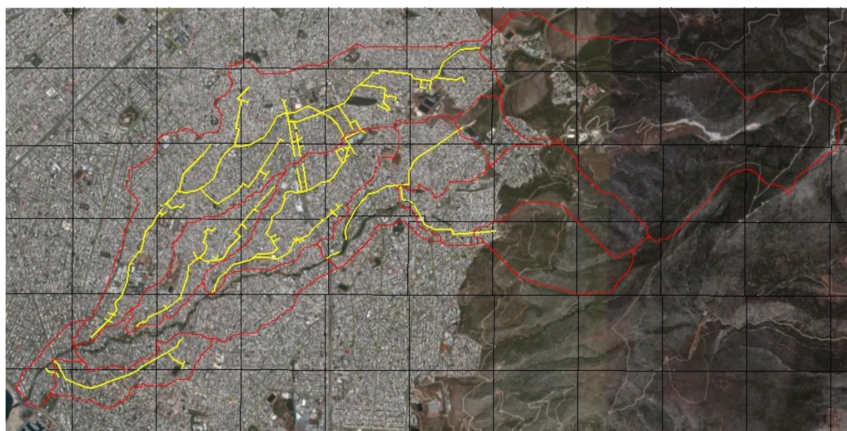
Σχήμα 1.8 Ανάπτυξη αγωγών αποχέτευσης ομβρίων εντός της λεκάνης απορροής
