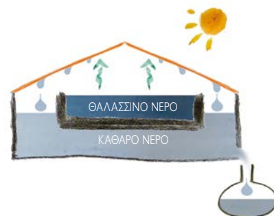
Αφαλάτωση με ηλιακή λίμνη. Το θαλασσινό νερό εξατμίζεται και συλλέγεται καθαρό, αφαλατωμένο νερό με κατάλληλη διάταξη.
