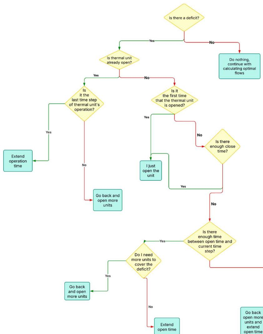
Εικόνα 1: Διάγραμμα ροής διαδικασίας λειτουργίας θερμικών μονάδων.
