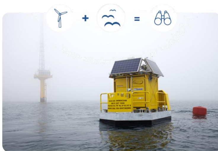
Εικόνα 6: Πλωτό σύστημα καταγραφής πλωτών Buoy (Πηγή: Akrocean)
