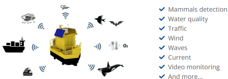
Εικόνα 7: Δυνατότητες καταγραφής πλωτών συστημάτων πλωτών Buoy (Πηγή: Akrocean)
