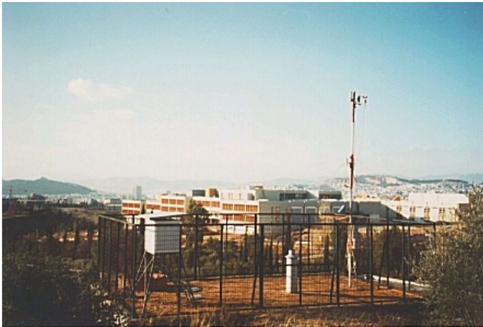
Σχ. 1: Ο χώρος του σταθμού και τα όργανα μέτρησης. Δεξιά είναι ο ιστός με τις συσκευές του σταθμού. Αριστερά είναι ένας μετεωρολογικός κλωβός με συμβατικά όργανα, και πίσω του ένα συμβατικό εξατμισίμετρο. Στη μέση ένας συμβατικός βροχογράφος.
