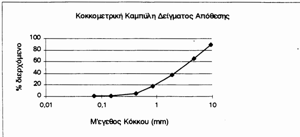
ΔΙΑΓΡΑΜΜΑ 4.2. : Κοκκομετρική Καμπύλη Δείγματος Απόθεσης
