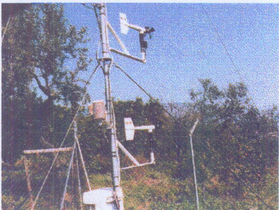
**Σχήμα 3.19** Αισθητήρες θερμοκρασίας, υγρασίας, ταχύτητας και διεύθυνσης του ανέμου, του Α.Μ.Σ. Επιδαύρου, σε ύψη 1.5 m και 3 m.
