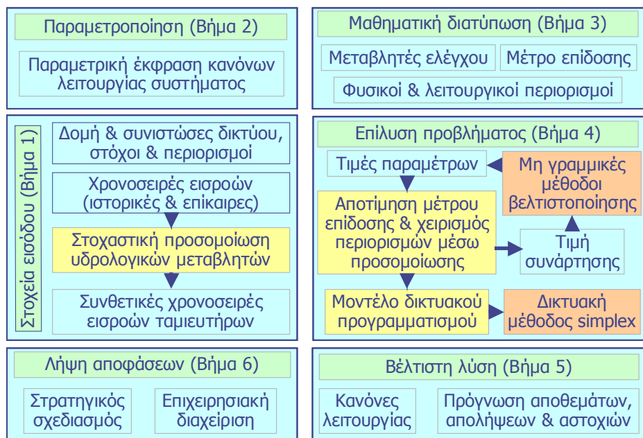
Σχήμα 2: Μεθοδολογικό σχήμα παραμετροποίηση-προσομοίωση-βελτιστοποίηση εφαρμοσμένο στον έλεγχο ενός υδροσυστήματος.
