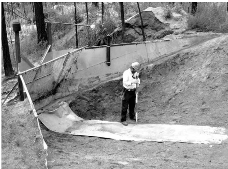
Εικόνα 5.2. Ζευγαρωτοί συλλέκτες φερτών υλικών (Robichaud et al, 2008(a)).
