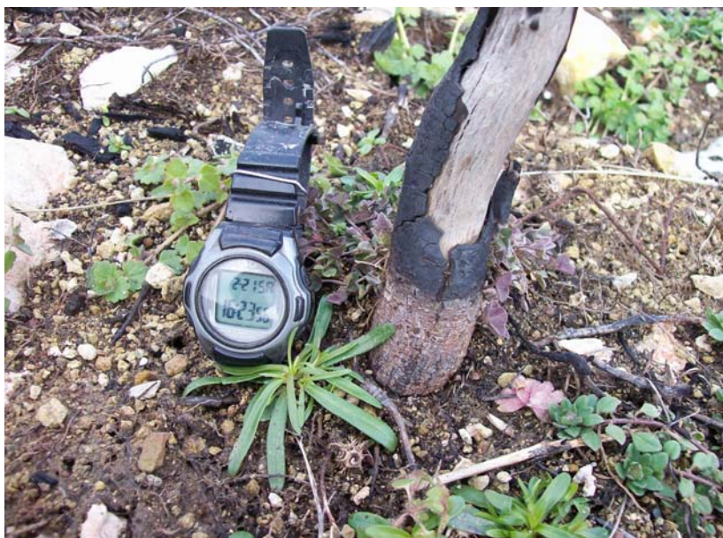
Εικόνα 6.8. Το μη μαύρισμα στη βάση του κορμού υποδεικνύει απώλεια εδάφους. Στην συγκεκριμένη περιοχή, η απώλεια είναι της τάξης των 3,5 cm (φωτ. από συγγραφείς).
