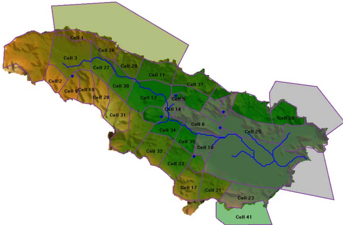
Σχήμα 7.5: Πολυκυτταρική σχηματοποίηση υδροφορέα και θέσεις καρστικών πηγών μοντέλου υπόγειας υδρολογίας.
